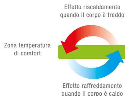
La tecnologia **Cell Solution® Clima** garantisce un controllo ottimale dell'umidità e della temperatura avvalendosi di materiali a cambiamento di fase (PCM- Phase Change Material) in grado di assorbire, immagazzinare e rilasciare il calore.
